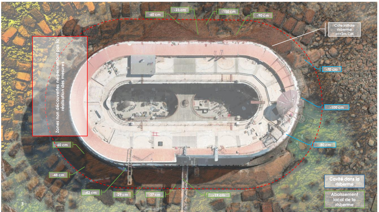
Figure illustrant les principales dégradations de la risberme.
